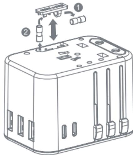
Zum Wechsel der Sicherung bitte wie folgt vorgehen:
