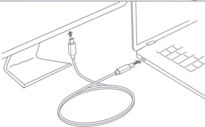
USB-C Stecker des Kabels an Gerät 1 anschließen
